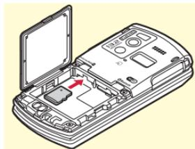
※ microSDカードを取り外すには、microSDカードを軽く押し、飛び出させてから引き出します。
