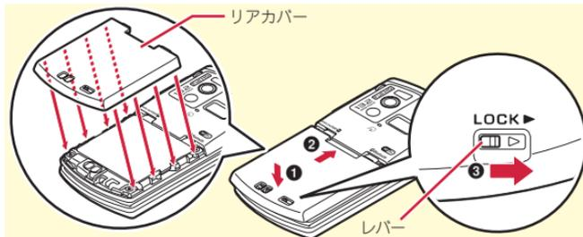
※ リアカバーが浮いていないように完全に閉じたことを確認してください。また、リアカバーのレバーを刻印されている矢印の方向にスライドさせ、しっかりとロックされた状態であることを確認してから使用してください。
