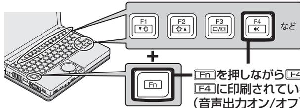
**[Fn]** を押しながら **[F4]** を押すと、**[F4]** に印刷されている機能 (音声出力オン/オフ) が働く
