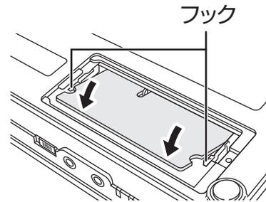
倒しにくい場合は、無理に力を加えず、再度モジュールの向きや挿し込み具合を確認してください。
