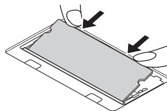
●挿し込みにくい場合は、無理に力を加えず、再度モジュールの向きを確認してください。
