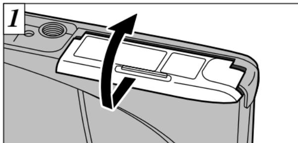
電池カバーを矢印方向にスライドさせてから開けます。
