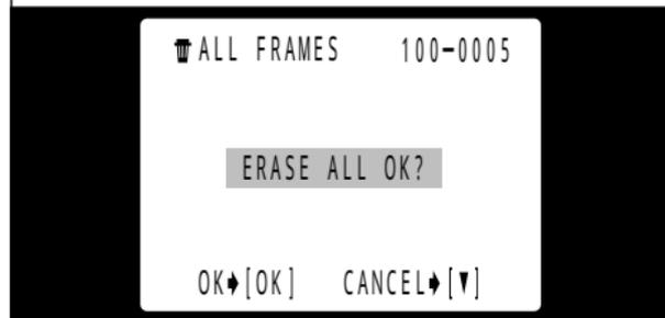
実行を確認する画面が表示されます。全コマ消去かフォーマットでは、OKなら“MENU/OK”を押して実行します。1コマ消去では消去したい画像を“◀▶”で選んでから、“MENU/OK”を押します。
