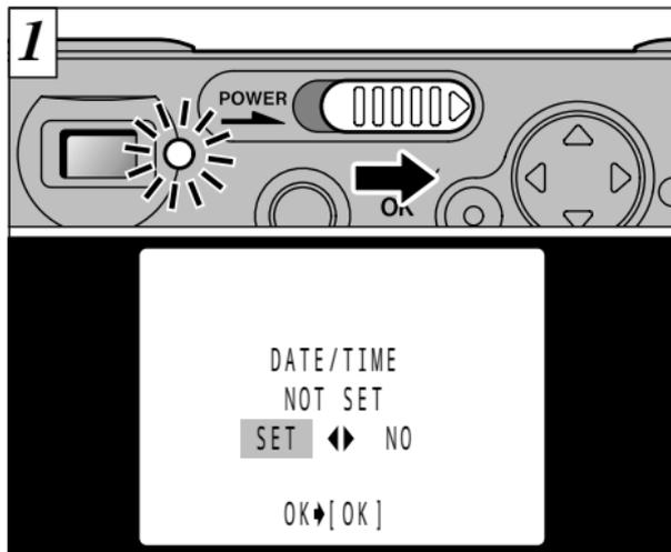
電源を入/切するには、“POWER”スイッチを矢印方向にスライドさせます。電源を入れるとファインダーランプ(緑)が点灯します。
