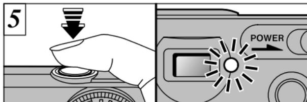
シャッターボタンを半押しして液晶モニターに“**STANDBY**”と表示されるか、ファインダーランプ(緑)が点滅から点灯に変われば、露出合わせ(AEロック(⇒20ページ))は完了です。
