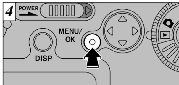
“MENU/OK”ボタンを押すと、表示している画像が消去されます。消去が終わると次の画像が再生され、“ERASE OK?”が表示されます。消去をやめ、メニューに戻るには“▼”を押します。
