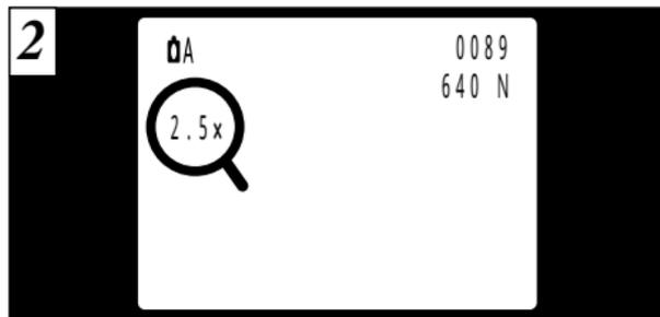
撮影時に“▲”を押すと拡大し、液晶モニターに倍率が表示されます。“▼”を押すと1段階前の状態に戻ります。
