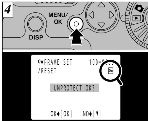
“MENU/OK”を押すと画像がプロテクトされ、液晶モニターの右上に“0m”が表示されます。プロテクトをリセットするには、もう一度“MENU/OK”を押します。
