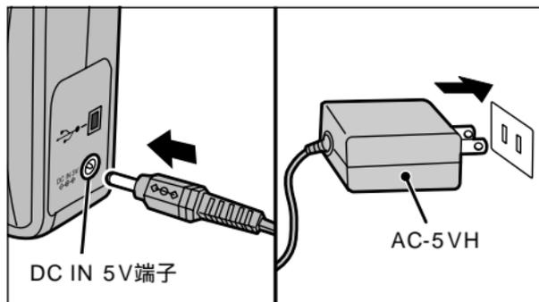
電池の消耗を気にせず撮影・再生で使用するには、専用のACパワーアダプターAC-5VHまたはAC-5V(別売)のご使用をおすすめします。カメラの電源が切れていることを確認してから、AC-5VH/AC-5Vの接続プラグをカメラの“DC IN 5V”端子に差し込みます。その後、AC-5VH/AC-5Vを電源コンセントに差し込みます。
