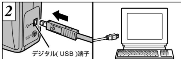
カメラのデジタル( USB )端子に専用USBケーブルの小さいプラグを接続し、もう片方のプラグをパソコンのUSB端子に接続します。パソコンの電源が入っていると液晶モニターの左上に“USB”が表示されます。
