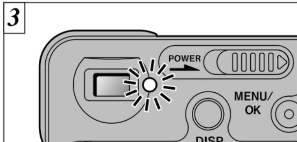
ファインダーランプが橙色に点灯または点滅しているときは、アクセス中(転送中)です。アクセス中は、絶対にスロットカバーを開けたり、ケーブルを抜いたりしないでください。データが転送されなかったり、カメラが正常に作動しない場合があります。
