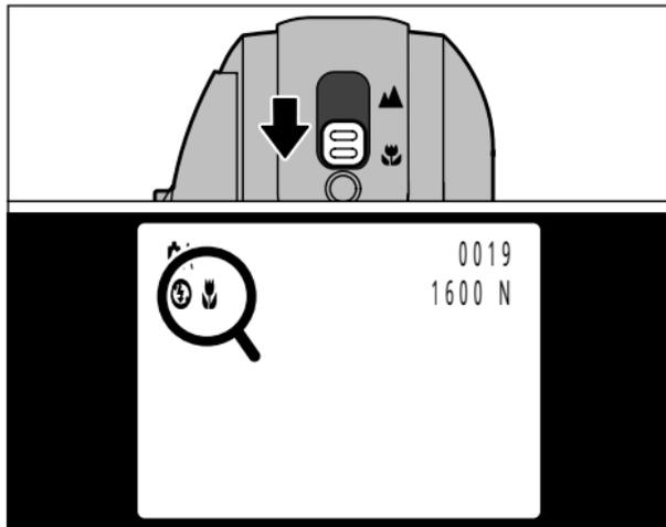
標準/マクロ切り換えスイッチを“🌸”側にすると、液晶モニターに“🌸”が表示され、マクロ撮影になります。
