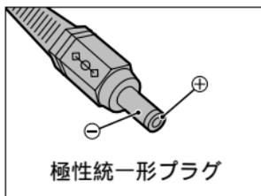
本機には、必ず専用のACパワーアダプターAC-5VH/AC-5V(別売、EIAJ規格・極性統一形プラグ付き)をお使いください。AC-5VH/AC-5V以外のACパワーアダプターをお使いになると本機の故障の原因になることがあります。
