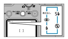
撮影の目的に合わせて5種類のストロボ撮影が 選べます。" ≠ "ストロボボタンを押すたびに、 液晶モニターに" オートストロボ(表示なし) ③ ≠ ③ S4 "の順に表示され、最後に表示
