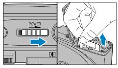
カメラの電源をOFFにして、スマートメディア を交換します。
