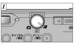
モードダイヤルを" **2** "に合わせます。1回の撮影で最長約80秒(320×240ピクセル・10フレーム/秒・Motion JPEG(➡85ページ)形式)の音声付きのムービーを撮影できるモードです。
