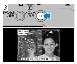
"メニュー/実行"ボタンを押すと、液晶モニター に見えている状態でトリミング設定が決定され ます。
