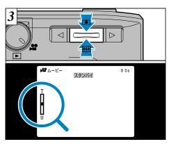
"▲▼"でデジタルズームができます。液晶モニターに"ズームバー"が表示されます。
