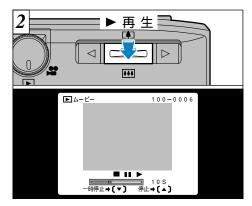
再生する場合は"▼"を押します。再生すると液 晶モニターに、再生中のバー表示と時間が表示 されます。
