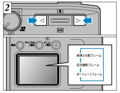
" **◆** "で3種類のフレーミングガイドを選択できます。フレーミングガイドは液晶モニターで撮影するときに、構図を決める際のめやすになります。
