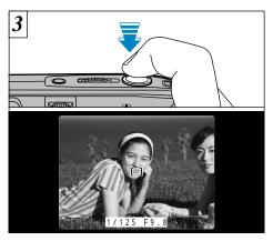
そのままシャッターボタンを半押し( AF/AEロック )し、液晶モニターのAFフレームが小さくなり、"シャッタースピード/絞り値"が表示( ファインダーランプ 緑 Jが点滅から点灯 )されるのを確認します。
