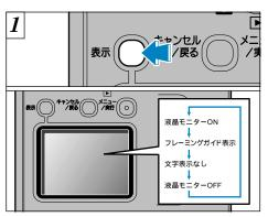
オート撮影では、"表示"ボタンを押すごとに液晶 モニターの表示が切り換わります。"表示"ボタ ンを押して"フレーミングガイド"を表示します。
