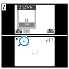
撮影モードが" □ A \* □ M "で設定できます。 "ON "にすると液晶モニターに、" 哟 "マークが 表示されます。
