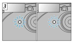
セルフタイマーランプが約5秒間点灯したのち 点滅に変わり、さらに約5秒後に撮影されます。
