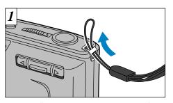
ストラップの小さい方の輪を、ストラップ取り 付け部に通します。
