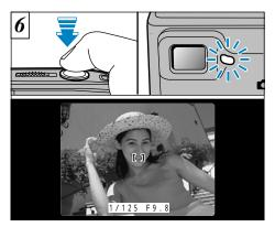
シャッターボタンを半押しすると、液晶モニターのAFフレームが小さくなり、"シャッタースピード/絞り値"が表示(ファインダーランプ、緑」が点滅から点灯)されるとピント合わせは完了です。
