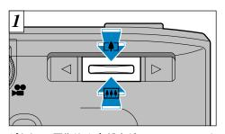
ピクセル(画像サイズ)設定が 1280×960 "または 640×480 "では、 ( ▲ 4 ) "を押すとデジタルズームになります。ただし、液晶モニターを使用した撮影でのみ有効です。
