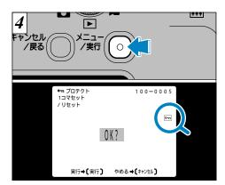
"メニュー/実行"ボタンを押すと画像がプロテクトされ、右端に" 🔄 "マークが表示されます。 プロテクトをリセットするには、もう一度
