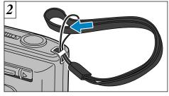
次に大きい方の輪の端を、小さい方の輪の中に 通して引っ張ります。
