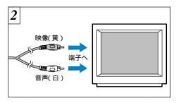
テレビの音声入力/映像入力端子にピンプラグを接続し、カメラとテレビの電源を入れて通常どおり撮影、再生を行ってください。
