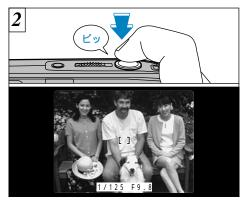
被写体にAFフレームを合わせ、シャッターボタンを押すとAFフレーム内に見えるものにピントが合い、セルフタイマーがスタートします。
