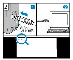
●カメラのデジタル(USB)端子に専用USBケーブルの小さいプラグを接続し、②もう片方のプラグをパソコン側のUSB端子に接続します。パソコンの電源が入っていると液晶表示モニターに
