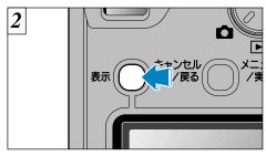
ファインダー撮影 マクロ撮影を除く)では 表示 "ボタンを3回押して、液晶モニターをOFFにします。消費電力を抑えた撮影ができます。
