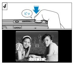
シャッターボタンを半押し(AF/AEロック)のまま最初の構図に戻して、さらにシャッターボタンを押し込みます。
