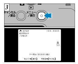
"メニュー/実行"ボタンを押して実行します。 液晶モニターにトータル枚数が表示され、その 後メニューに戻ります。
