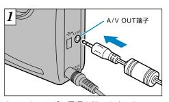
カメラとテレビの電源を切ります。カメラの "A/V OUT(音声/映像出力)"端子にA/Vケーブ Jル(付属品)のプラグを接続します。
