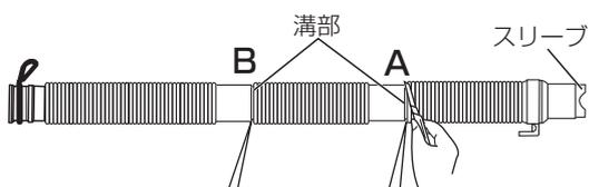
本体と排水口の距離に応じて、溝部2ヶ所A・Bのうち、どちらかの溝部を切って先端にスリーブをはめ直してください。
