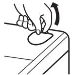
2 乾燥機の排水ホースが使用中に抜けないようにしっかり排水口の奥まで差し込む
