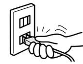
コードを引っ張ると、コードが破損し、感電・ショート・火災の原因になります。
