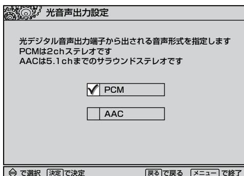
「PCM」 …… 音声AACに対応していないオーディオ機器を接続の場合に設定します。
