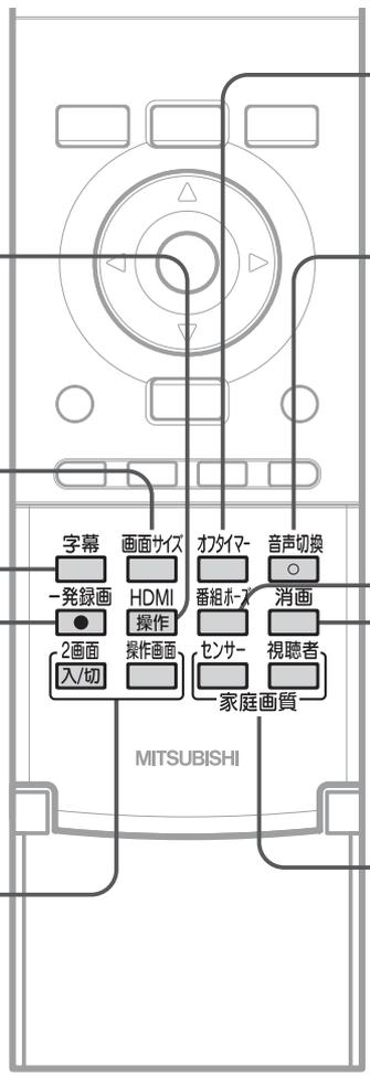
HDMI端子を使って接続している機器を本機のリモコンで操作する。 **P.58**
