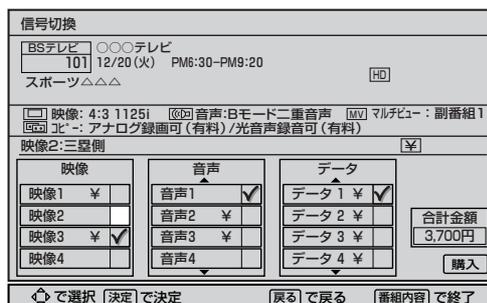
映像信号は最大4種類、音声信号は最大8種類、データ信号は最大16種類まであります。
