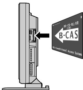
挿入方向は、挿入口の表示を参考にしてください。本体前面から見てB-CASカードの矢印の絵柄が見えるようにして、カード絵柄の矢印の方向です。
