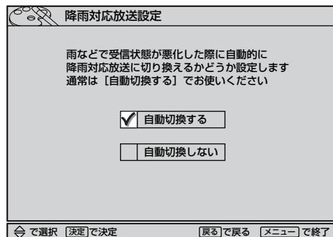
「自動切替する」… 受信状態に応じて、自動的に降雨対応放送に切り換えます。
