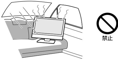
熱・振動により壊れて、火災・感電の原因になります。
