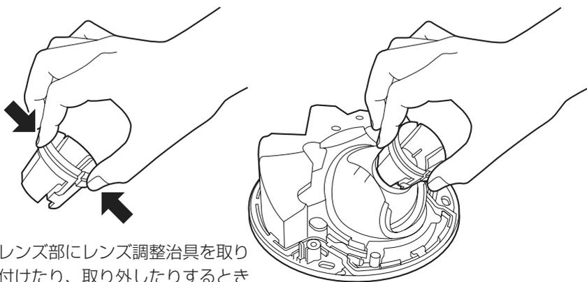
レンズ部にレンズ調整治具を取り付けたり、取り外したりするときは、レンズ調整治具の太い方を図のように押さえてレンズ部に付ける部分を開いてください。
