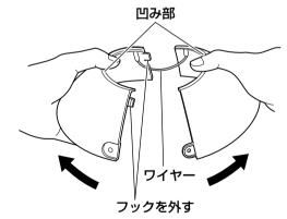
②フロント/リアサンシールド(付属品)をハウジング着脱台をはさみ込む位置にもっていきます。
