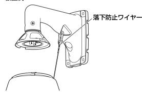
④ハウジング着脱台にカメラ部を取り付けます。 カメラ部上部にある位置決めピンが、ハウジング着脱台の刻印「REAR」側になるようにし、 ハウジング着脱台にカメラ部を取り付けます。 カメラ部下方から見て反時計回りに回し、固 定されたことを確認します。ハウジング着脱 台を取り外したときに外したねじ\*で、しっかりと締め付けてください。
