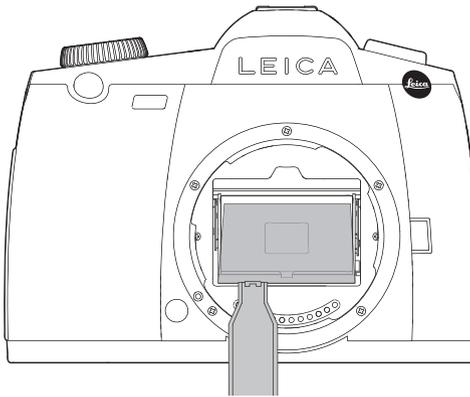
3. ファインダースクリーンの底辺にある小さな突起部分をピンセットで挟み、軽く上に持ち上げながらファインダースクリーンを取り出します。
