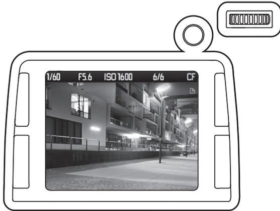
1. クリックホイールを短く押し（1.18、1秒以内）、画像切り替えモードとズーム（拡大）モードを切り替えます。
