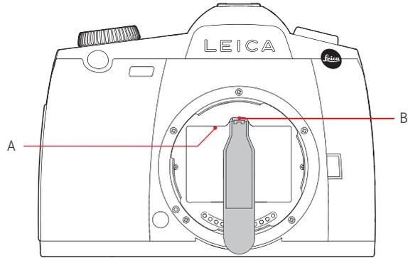
2. ピンセットの先端で止め具（B）を押して、スクリーンマウント（A）のロックを外します。ロックが外れると、ファインダースクリーン（C）が乗ったスクリーンマウントが下りてきます。
