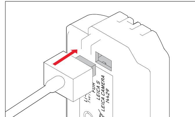
1. バッテリーチャージャー (B) の3ピンプラグ (1.45a) をバッテリーのソケット (1.44) に差し込み、電源プラグ (1.49/1.49b) をコンセントに差し込みます。
