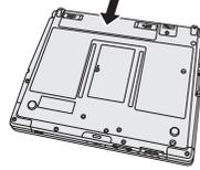
指定（付属および指定の別売り商品）以外のバッテリーパックを使用すると、発熱・発火・破裂の原因になります。
