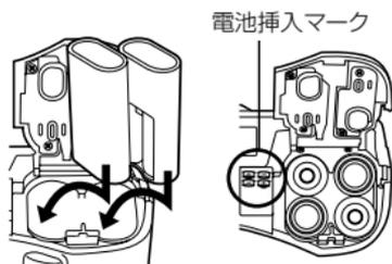
リチウム電池パックのとき 単3電池のとき
