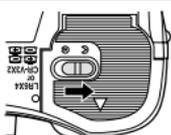
**3** 電池カバーをAの方向へスライドさせてから、Bの方向に開けます。
