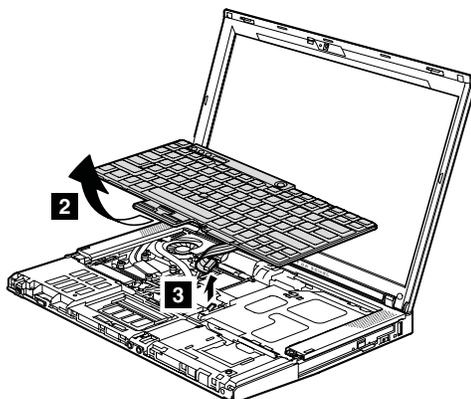
取り付け時の注意: キーボードのエッジ **a** がこの図で示されているようにフレームの下に入っていることを確認してください。
