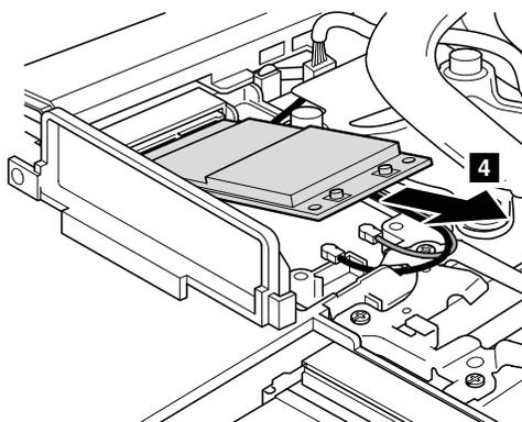
**取り付け時の注意:** 赤のケーブルは、カード上の **MAIN** のラベルが付いたジャックに差し込み、青のケーブルは、**AUX** のラベルが付いたジャックに差し込んでください。
