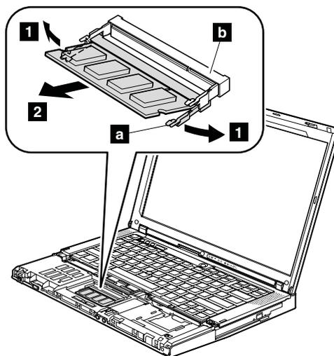
**取り付け時の注意:** DIMM の切り欠きのある端をソケットに挿入します。DIMM をしっかりと押し、定位置にカチッとハマるまで倒します。DIMM がスロットにしっかりと固定され、簡単に動かないことを確認してください。
