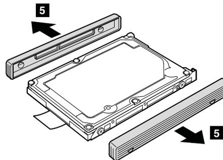
取り付け時の注意: ハードディスクのゴム製レールを交換用ドライブに取り付ける必要があります。そうしないと、ドライブを正しく取り付けられません。
