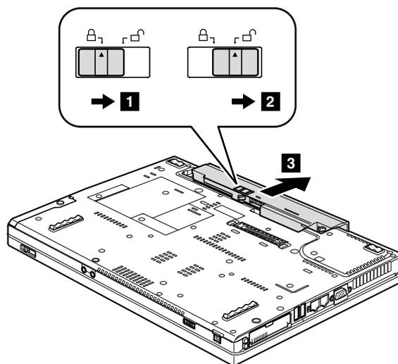
**取り付け時の注意:** バッテリー・パックをスロットのレールに沿って取り付けます。次に、バッテリー・リリース・レバーがロック位置にあることを確認します。
