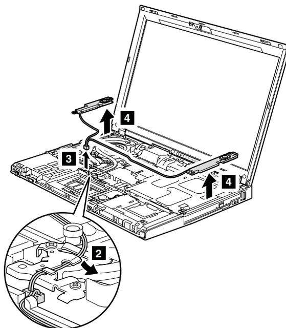
**取り付け時の注意:** スピーカー・コネクタがしっかりと接続されており、ケーブルが次の図のように配線されていることを確認してください。
