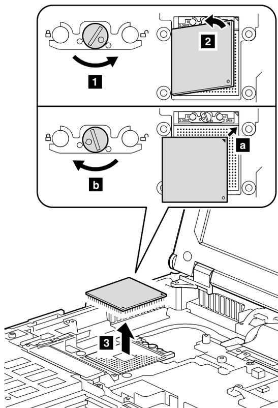
**取り付け時の注意:** CPU を CPU ソケット **a** の上に載せ、ねじの頭を矢印の方向 **b** に回転させて、CPU を固定します。
