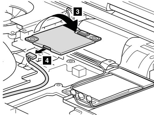
**取り付け時の注意:** モデム・コネクタとカードの下側のコネクタがしっかりと接続されていることを確認してください。
