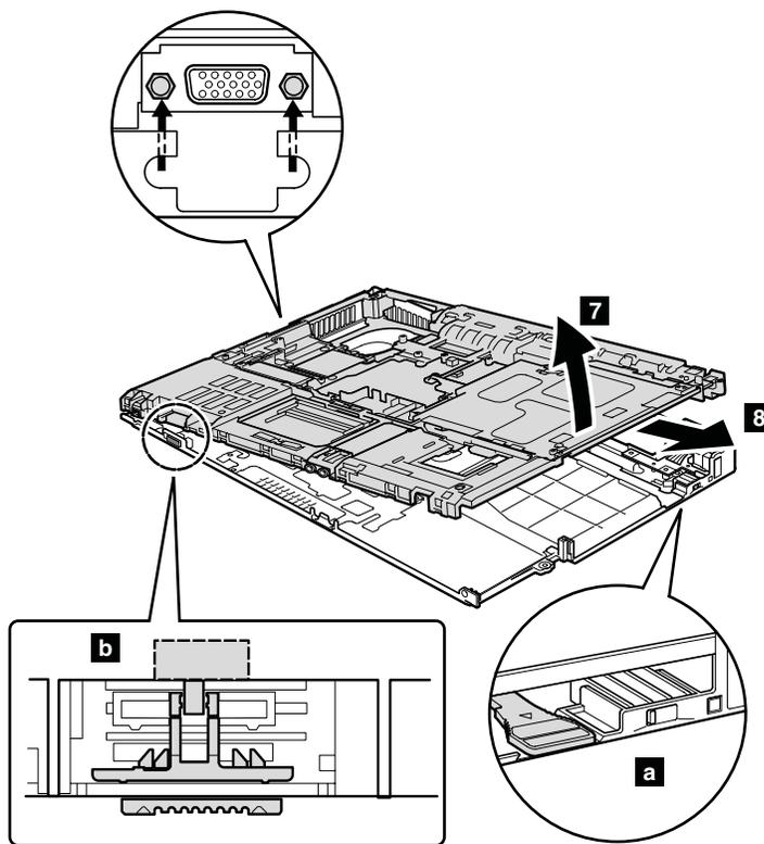
**注:** ベース・カバーを取り付ける場合、ワイヤレス・スイッチの位置を確認し、フレーム **b** にしっかりと取り付けてください。
