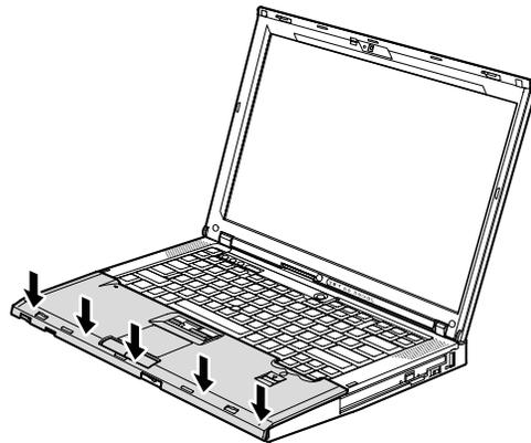
4. LCD カバーを閉じ、ThinkPad を裏返します。次に 4 つのねじを締めて、パームレストを固定します。
