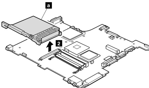
**取り付け時の注意:** カード・スロット・アセンブリーのコネクタがシステム・ボードにしっかりと接続されていることを確認してください。
