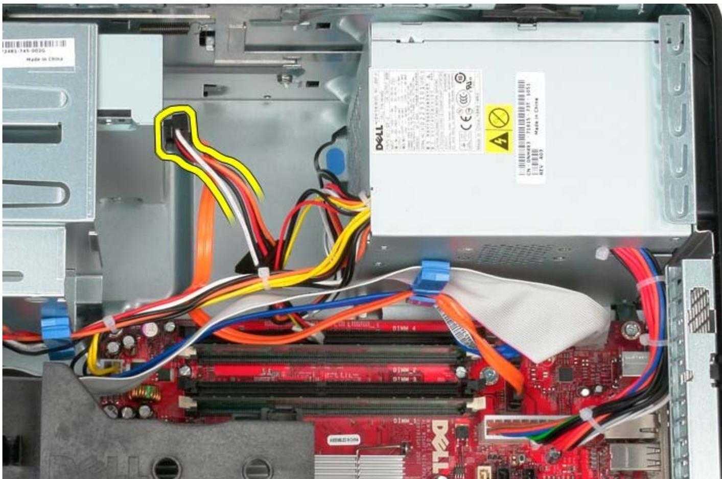
□□□ プロセッサ電源コネクタをシステム基板から外します。
