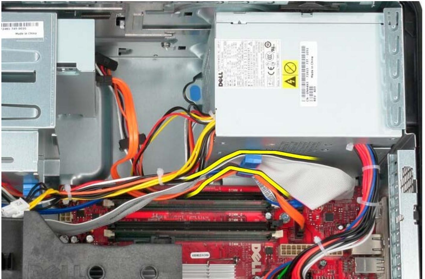
□□□ 電源ユニットの底にあるケーブル配線にあるデータケーブルを外します。
