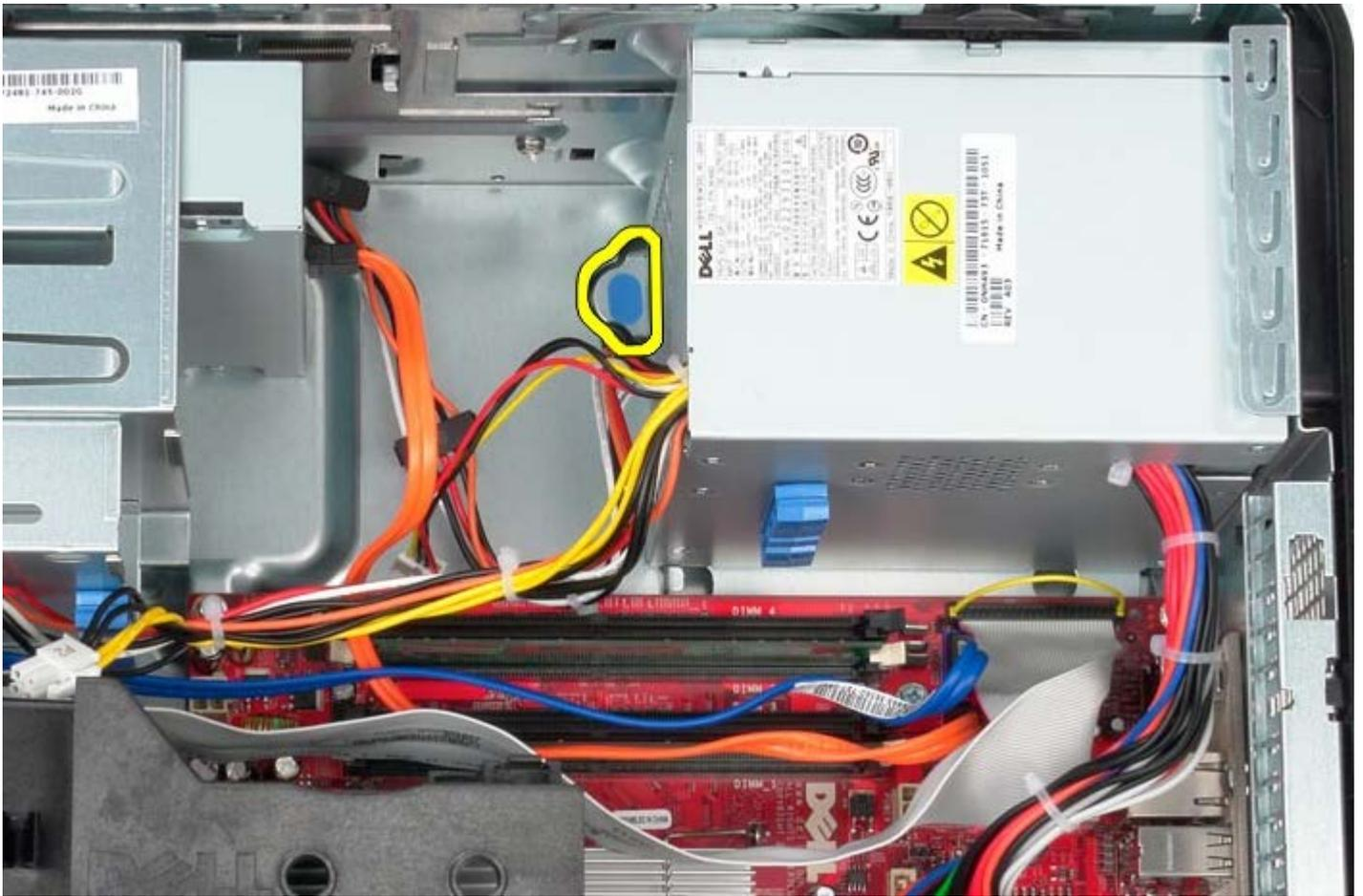
□□□□ 電源ユニットをコンピュータの前面に向かってスライドさせ、持ち上げながら、コンピュータから取り外します。
