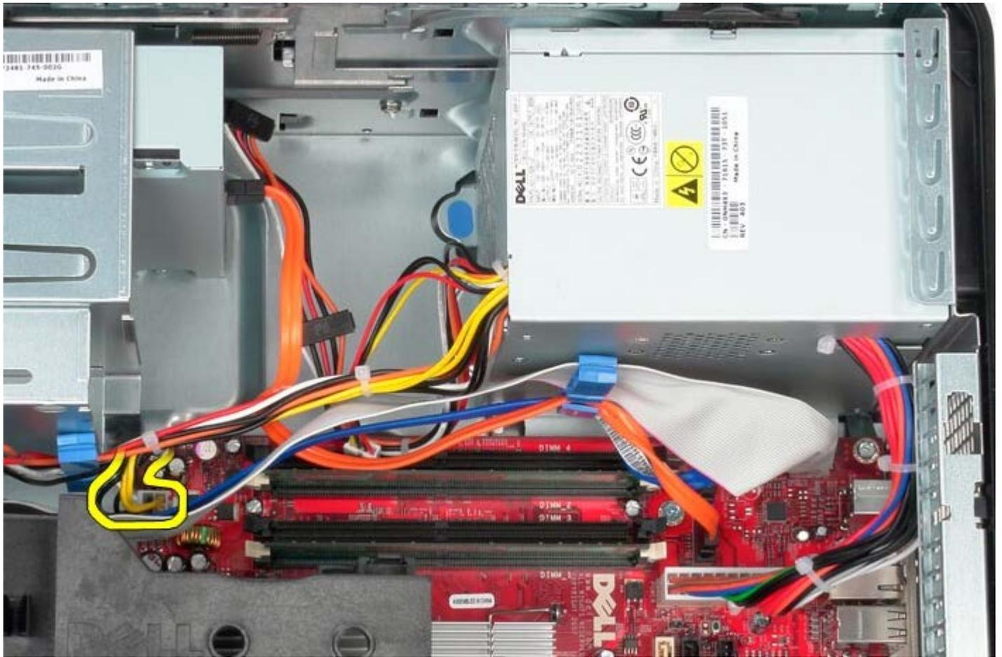
□□□ メイン電源ケーブルをシステム基板から外します。
