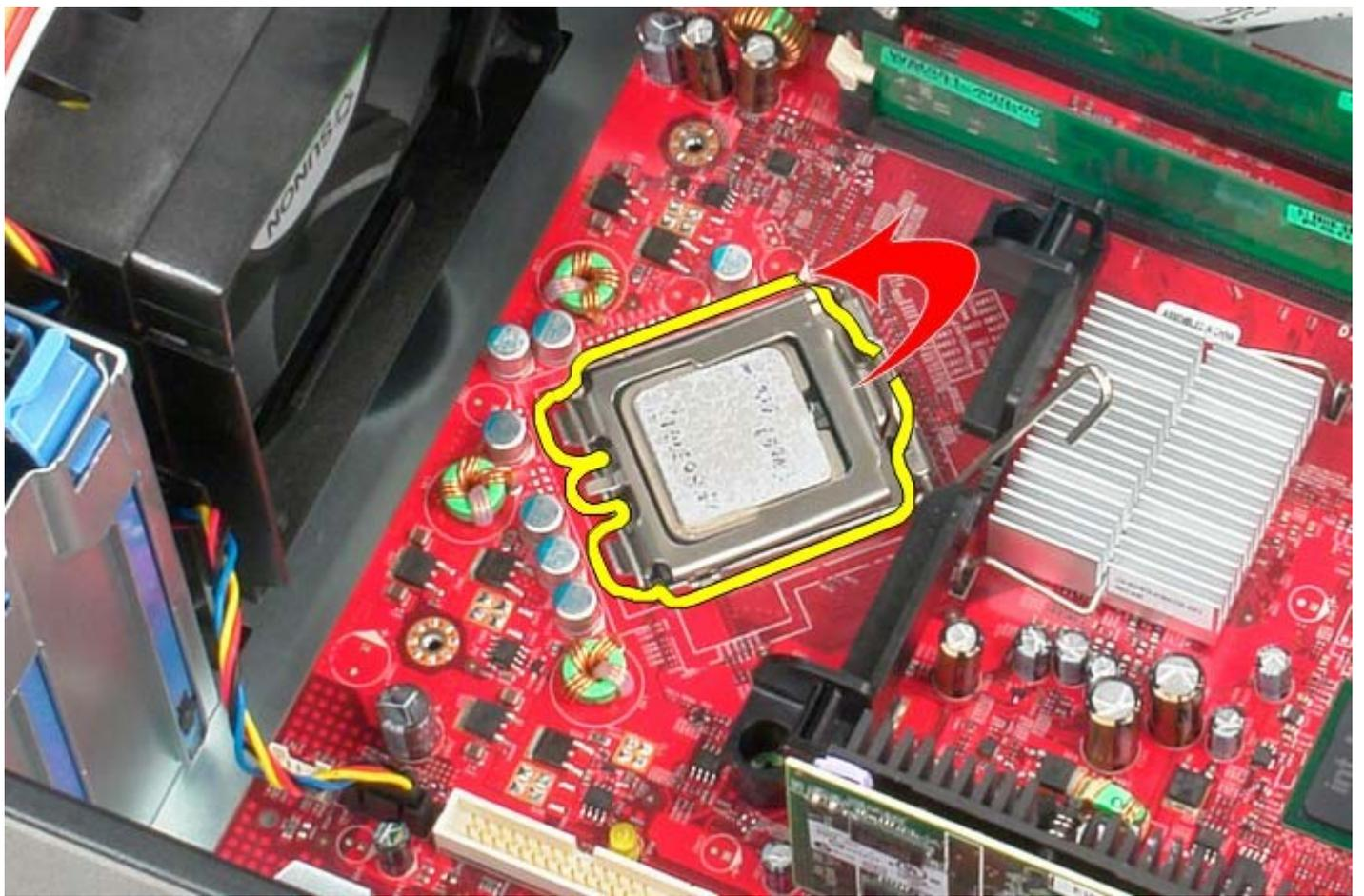
□□□ プロセッサをシステム基板から取り外します。
