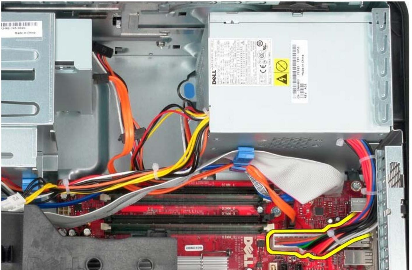
□□□ 電源ユニットの底にあるケーブル配線から IO パネルデータケーブルを外します。
