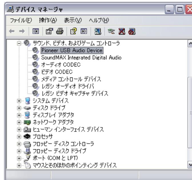
上記表示がない場合は、N-50 の入力が **Digital In USB** であることを確認してから、ケーブルを挿入し直すか、電源を一度スタンバイにしてからオンにし直すと再認識されます。
