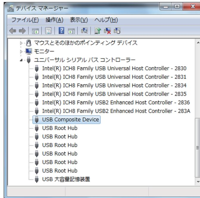
上記表示がない場合は、N-50 の入力が **Digital In USB** であることを確認してから、ケーブルを挿入し直すか、電源を一度スタンバイにしてからオンにし直します。
