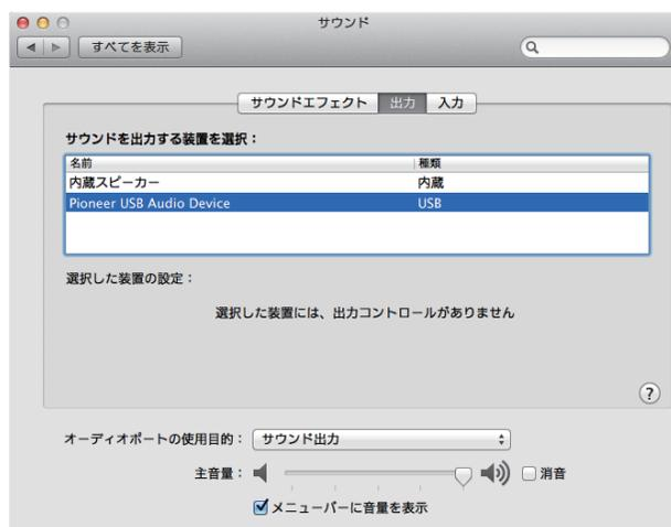
上記表示がない場合は、N-50 の入力が Digital In USB であることを確認してから、ケーブルを挿入し直すか、電源を一度スタンバイにしてからオンにし直します。
