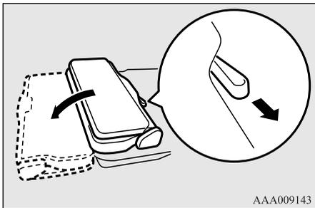
4. シートベルトのバックルをフロアの切り抜き部に格納します。
