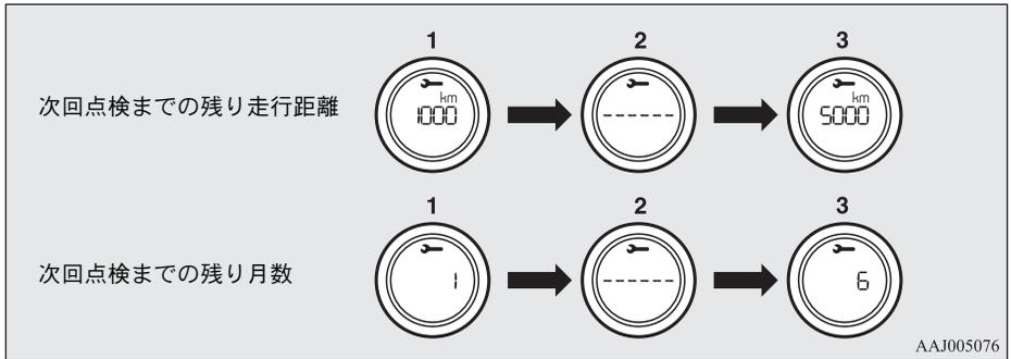
1. 次回点検までの残り走行距離または次回点検までの残り月数を表示します。
