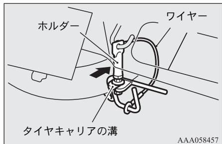
4. ホイールナットレンチを使用して、タイヤキャリア取り付けボルトを確実に締め付けます。
