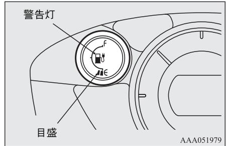
パワースイッチが ON のときに駆動用バッテリー残量計の目盛が2つ以下になると、つぎのように警告灯、目盛が点滅します。
