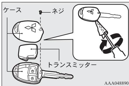
3. 先端に布をかぶせたマイナスドライバーなどを差し込んでトランスミッターを開きます。
