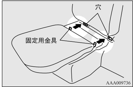
5. 元に戻した後はシートクッションを軽くゆすり、シートクッションが確実に固定されていることを確認します。
