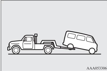
セクターレバーを①に入れ、パワースイッチをACCにして、ハンドルをロープなどで直進状態に固定してください。パワースイッチは絶対にLOCKまたはONにしないでください。
