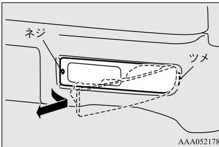
2. ソケットを反時計回りに回して外します。
