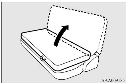
4. 背もたれとクッションの間を通してシートベルトのバックルを元の位置に戻します。
