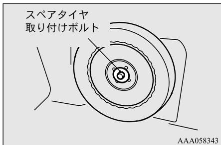
3. ホイールナットレンチを使用して、スペアタイヤががたつかない程度に、スペアタイヤ取り付けボルトを締め付けます。
