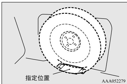
2. スペアタイヤ取り付けボルトでスペアタイヤを固定します。
