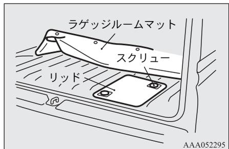
5. 補機用バッテリーの液量を確認します。
