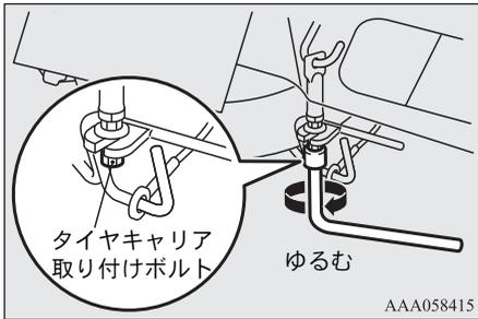
3. ワイヤーがタイヤキャリアに装着されていることを確認し、タイヤキャリアを持ち上げてホルダーから外し、下に降ろしてタイヤを取り出します。
