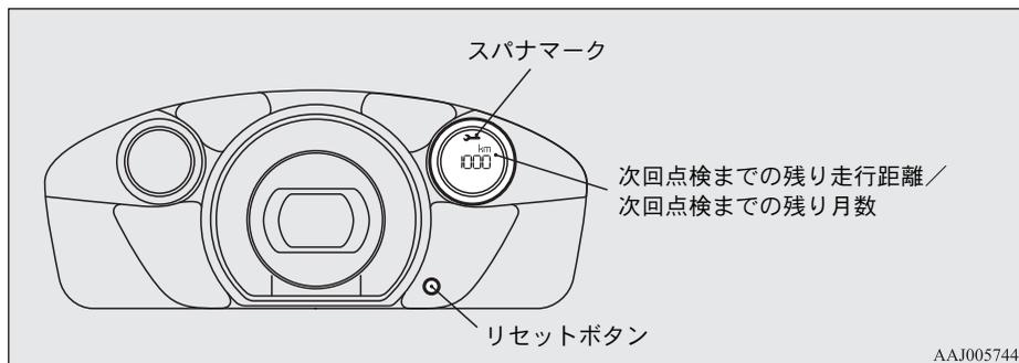
新車1ヶ月点検(1.000km), 新車6ヶ月点検(5.000km)とその後の12ヶ月ごとの定期点検までの残り走行距離または残り月数を表示します。
