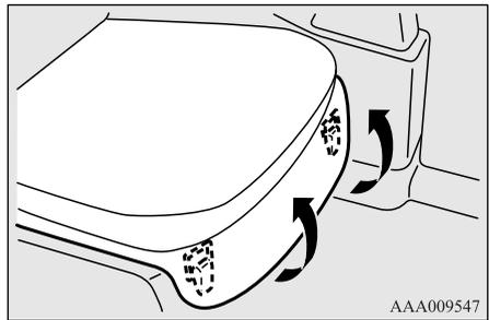
3. シートクッション下側のレバーを引き上げロックを外します。
