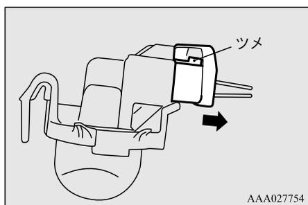
3. レンズの両端を押しながらレンズをランプ本体から外し、バルブを引き抜きます。
