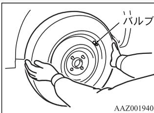
3. 手でホイールナットを右へ回して仮締めします。
