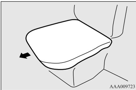
4. 元に戻すときはシートクッション固定用金具を背もたれ下の取り付け穴に差し込み、取り外すときと逆の手順で固定します。
