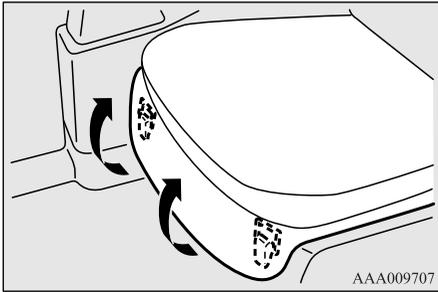
2. シートクッション下側のレバーを引き上げロックを外します。
