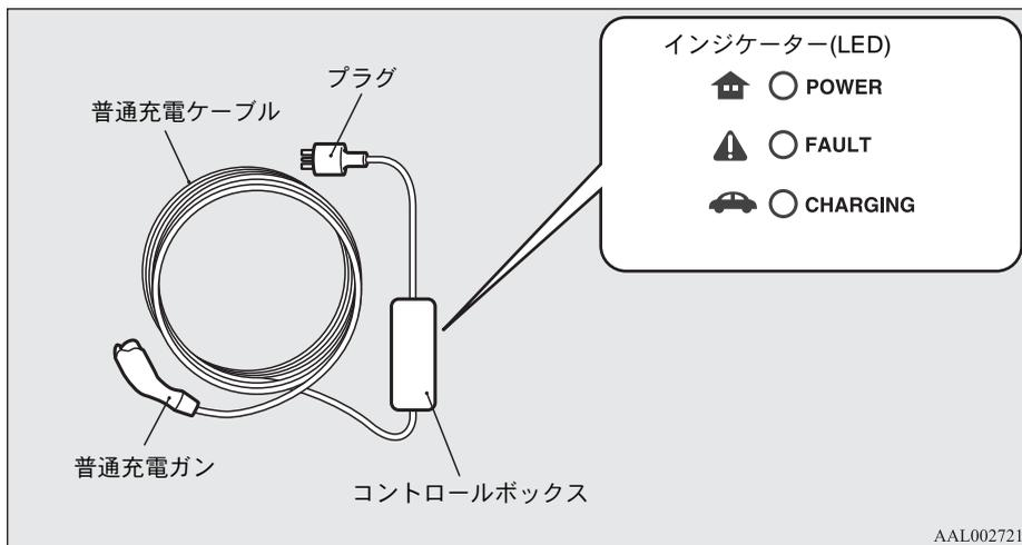
インジケータは以下の状況で点灯、点滅します。
