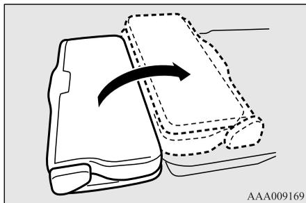
2. シート後部をカチッと音がするまで押し付けるか、またはシートを少し持ち上げた位置（約 30cm）から離し確実に固定します。
