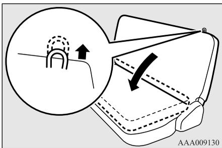
3. シート後方のバンドを引いてロックを外し、シート全体を前方へ倒します。
