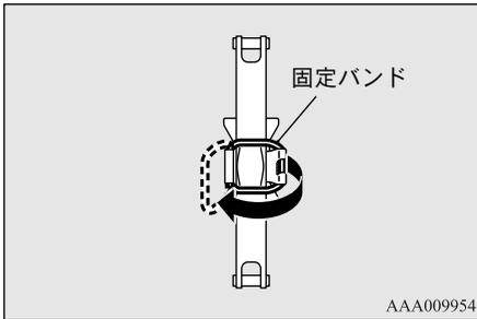
3. ジャッキマークが付いている側を上にして、ジャッキカバーを確実に取り付けます。
