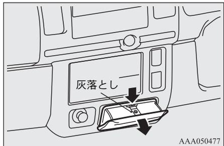
取り付けるときは、灰皿下部を溝に差し込んでから灰落としを押ししたまま押し込みます。
