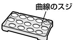
→ ●部品の成型時に注入された、プラスチック材料が合流した場所や、金型の接合部にスジが入ることがあります。
