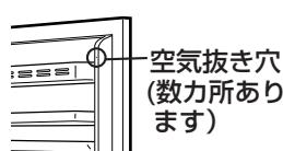
→ ●生産時の、ドア内部にウレタン樹脂を注入し発泡させる工程において、内部の空気を抜くために設けられた穴です。
