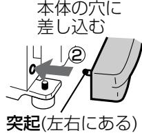
蒸発皿・カバーの取り付けが悪いと水漏れや異常音の原因になります。
